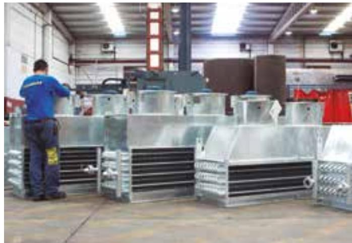
Fabricación de enfriadores de aleta plana, con separación entre aletas desde 4 a 20 mm., en las geometrías 60x60 (EV6) de formato triangular y geometrías 70x70 (EV7) de formato en ángulo recto, en acero carbono galvanizado e inox. con tubo de 21,3 mm. ( $\frac{1}{2}$ "). Para túneles de congelación, cámaras frigoríficas con temperaturas desde -60° a + 10° con bandejas desescarche, plenum y ventiladores.
