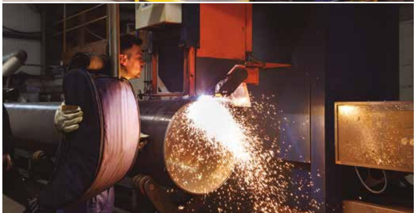
Líneas de curvado automático para tubos desde Ø 21,3 mm hasta Ø 219,1 mm en radios de 1D, 1.5D, 2D y 3D.
