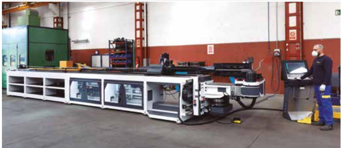
Curvadora de rodillos para tubos hasta Ø 219,1mm
